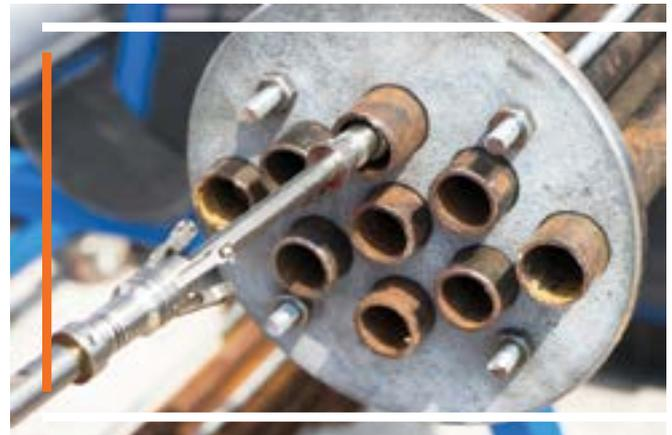
tube. Comme la valeur de la vitesse de propagation des ondes ultrasonores à travers la matière est connue, il est possible d'évaluer l'épaisseur de la paroi en calculant la différence du temps de propagation des ondes entre le diamètre intérieur et extérieur du tube. De ce fait, l'IRIS permet de détecter des défauts sur la paroi intérieure et à l'extérieur du tube.
